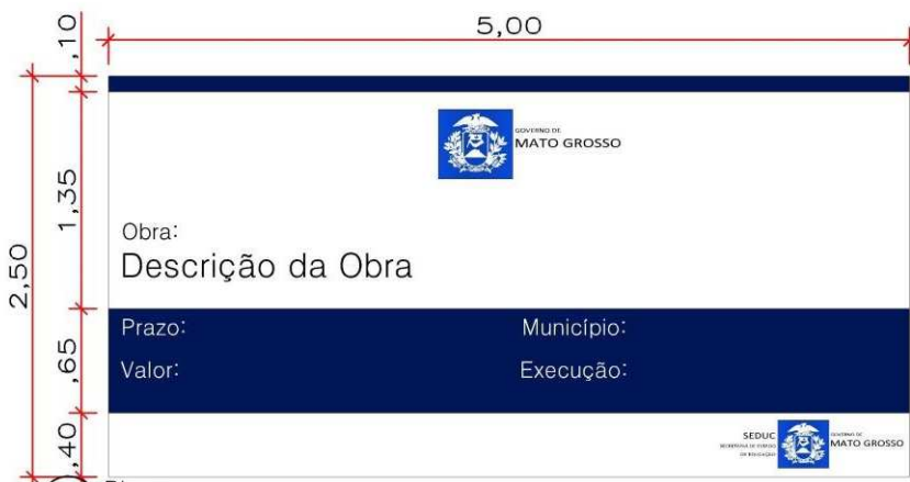
Figura 1 - Placa de obra. Fonte SEDUC.
